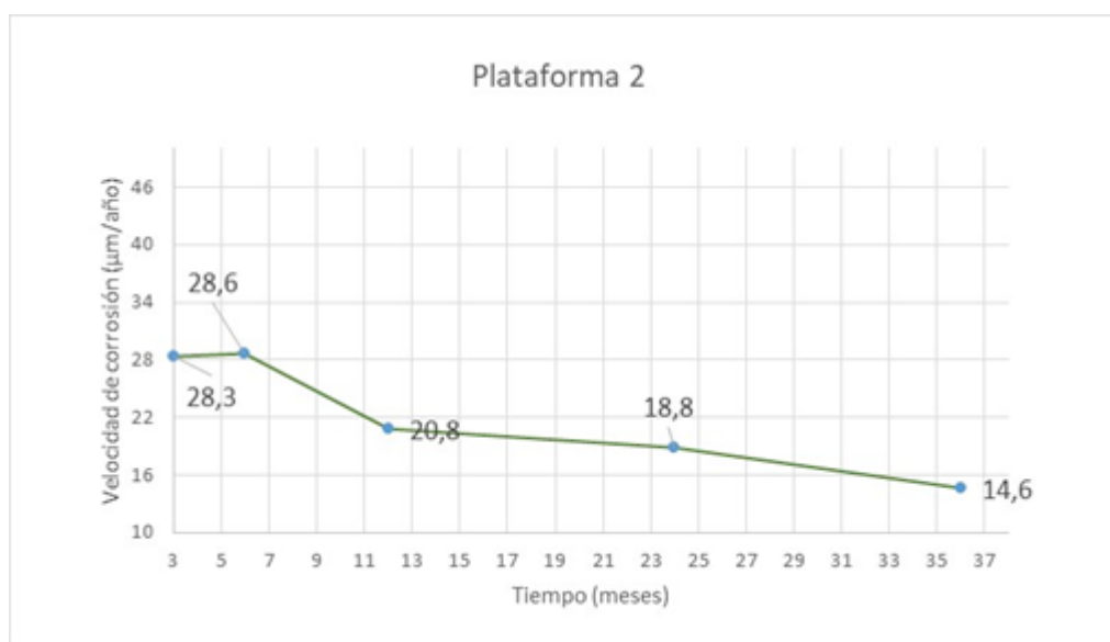
Figura 49. Velocidad de corrosión, determinada por método gravimétrico, para un periodo de exposición de 3, 6, 12 y 24 meses, en el sitio de monitoreo: Plataforma 2.
