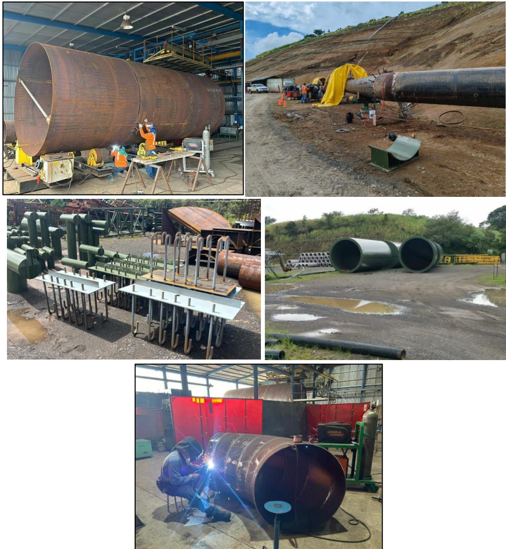
Figura 174. Estructuras metalmecánicas producidas para el PG Borinquen en el taller de estructuras en el CG Las Pailas.
