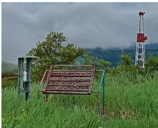
Figura 48. Estación de monitoreo de corrosión en PLB-05.
