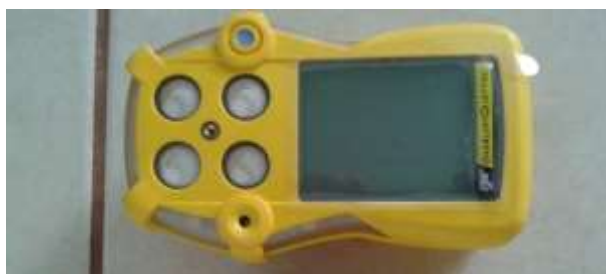
Detectores de fugas de H2S.
