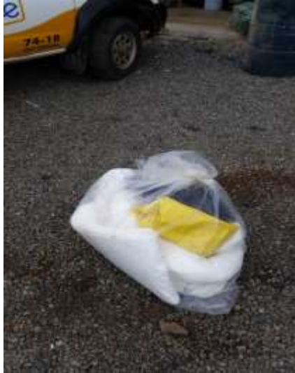
Figura 40. Kit de atención de derrames entregado a camiones cisterna.
