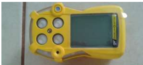
Detectores de fugas de H 2 S.
