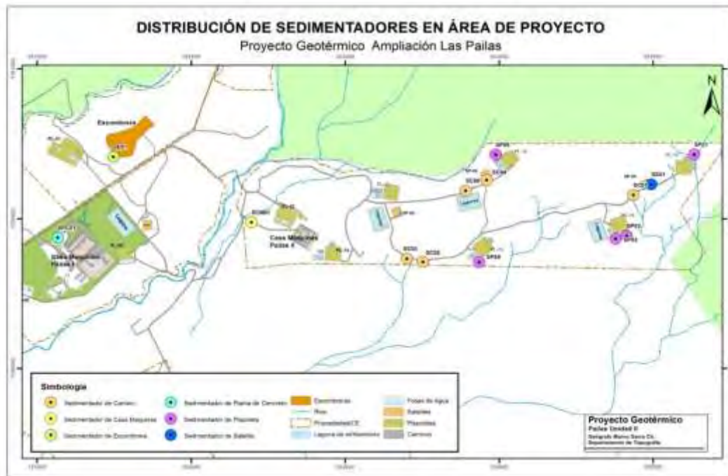
Figura 31. Ubicación de sedimentadores en el Proyecto Geotérmico Las Pailas.
