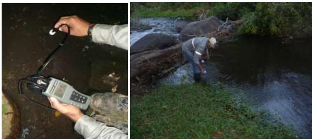
Figura 52. Mediciones directas de parámetros físico químicos y toma de muestras para calidad de cuerpos de agua del PG Las Pailas II.
