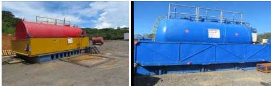
Figura 17. Tanques de combustible en perforadoras
