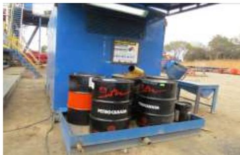
Figura 18. Área para el manejo de residuos de aceites usados
