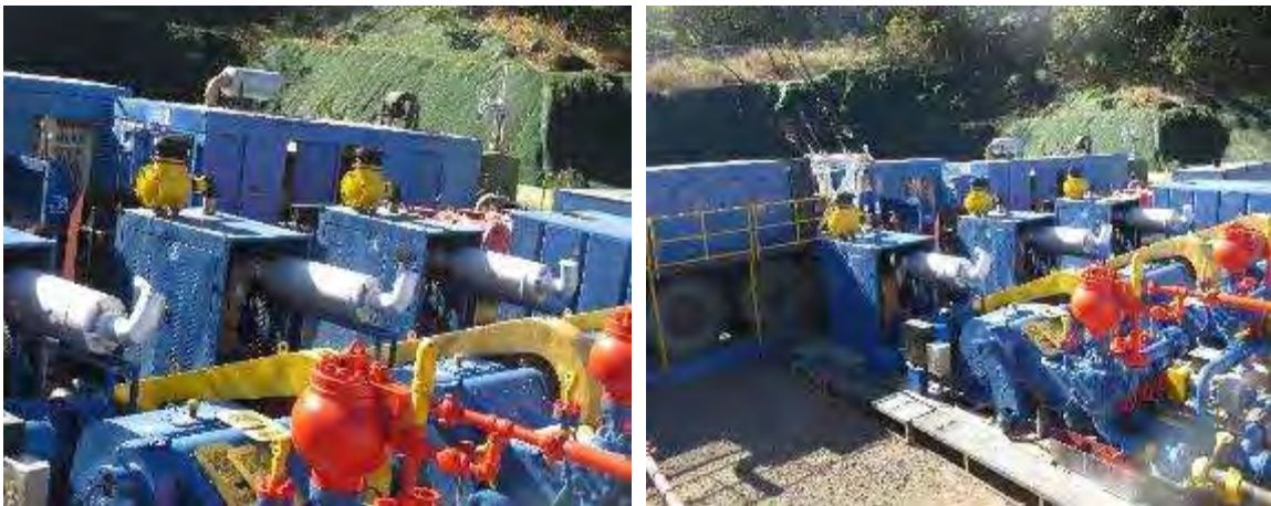
Figura 9: Sistemas de escape de equipos de perforación Cardwell KB-700.
