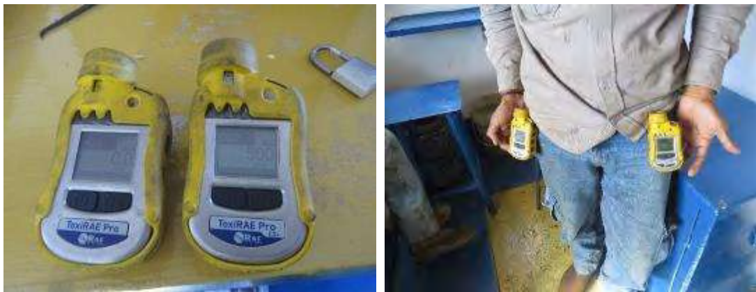
Figura 12: Detector portátil de gas utilizados en pozos geotérmicos.
