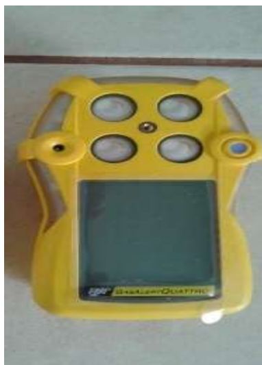
Figura 21. Detectores de fugas de H 2 S.
