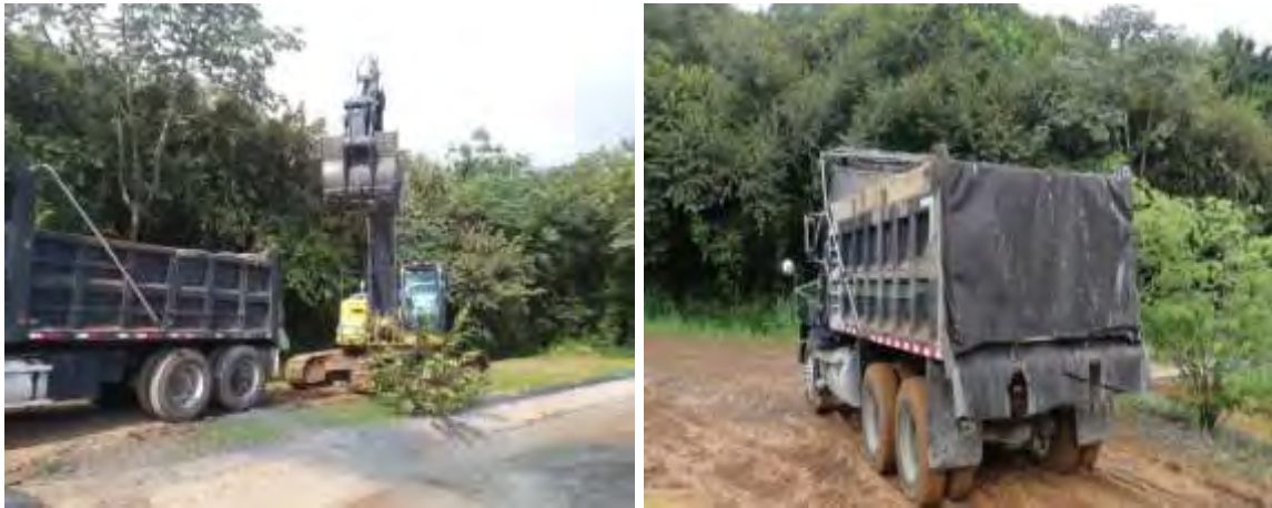
Figura 143: Adaptación de geotextil en compuerta de vagonetas utilizadas durante el traslado.
