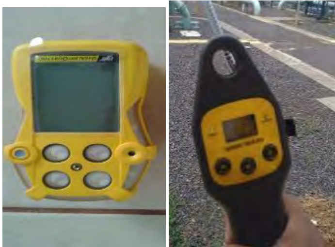
Figura 37. Detectores de fugas de pentano y H 2 S, diciembre 2018.
