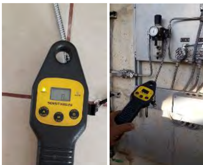
Figura 8. Medición de fugas de pentano. El equipo está en buen estado, diciembre 2018.
