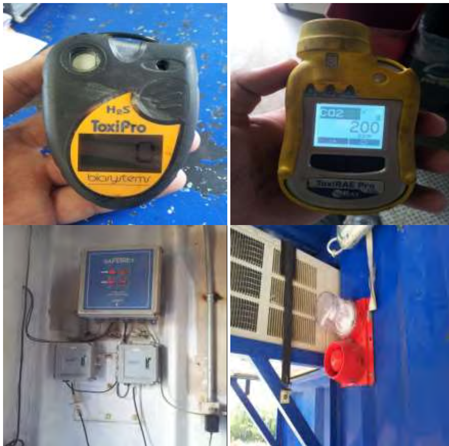
Figura 1. Detectores portátiles y fijos con alarmas audibles de H 2 S y CO 2 .
