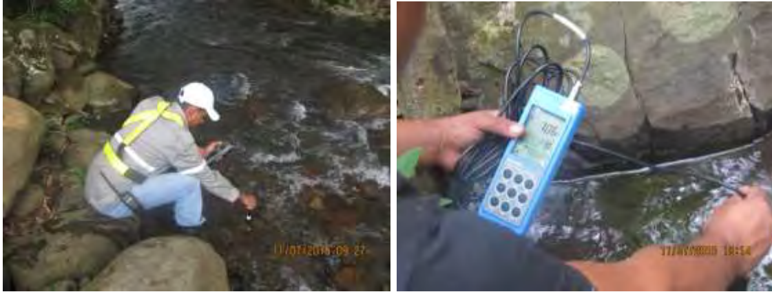
Figura 57. Mediciones directas de parámetros físico químicos para calidad de cuerpos de agua del PG de Ampliación Las Pailas.
