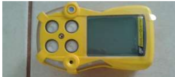
Detectores de fugas de H 2 S.
