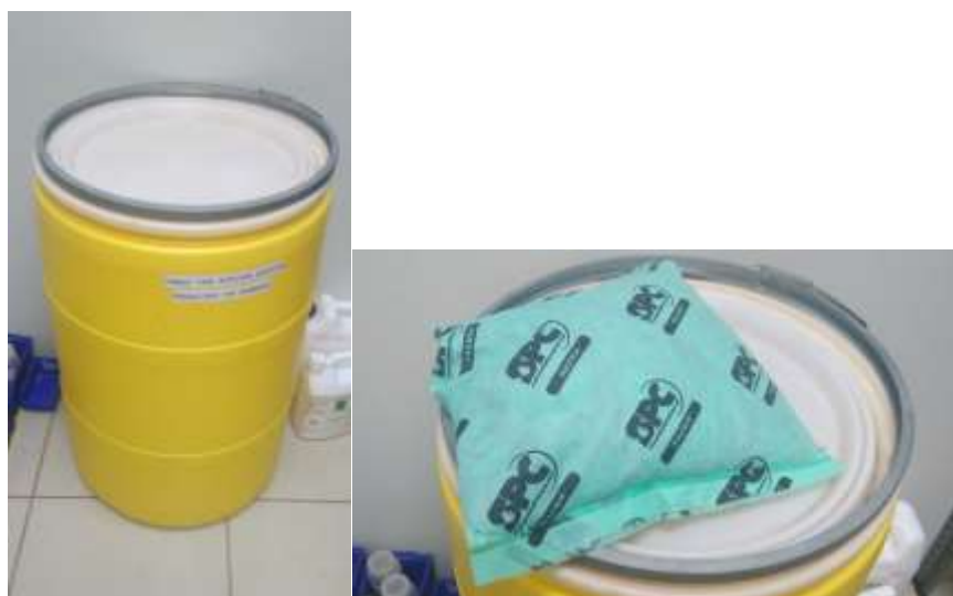
Figura 22. Kit de control de derrames del área química y msds.
