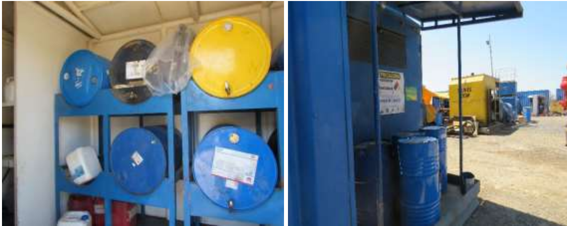
Figura 58. Áreas para almacenamiento de sustancias peligrosas en perforadoras.
