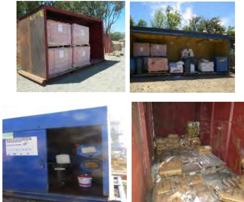
Figura 64: Áreas para almacenamiento de sustancias peligrosas en perforadoras
