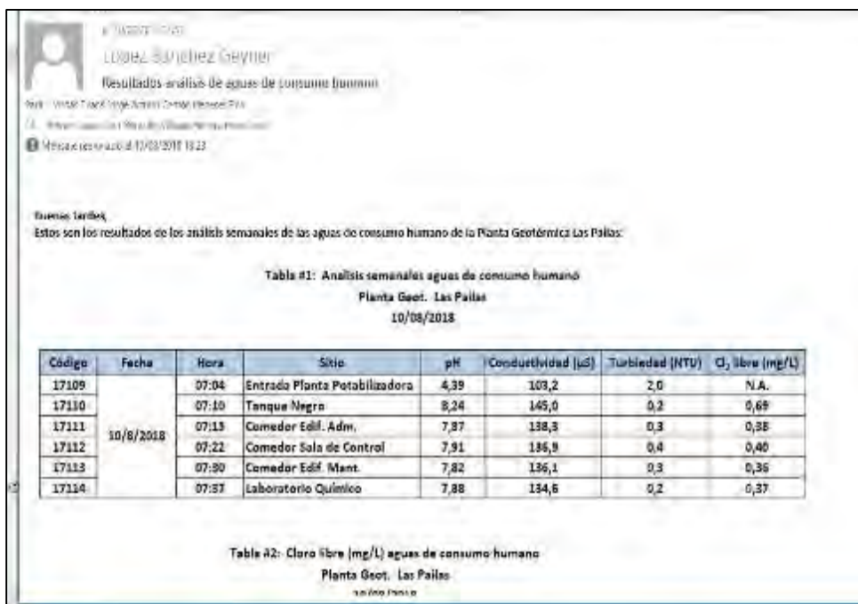
Figura 61. Análisis semanal del agua de consumo humano. Contenido de cloro normal en varios puntos, agosto 2018.
