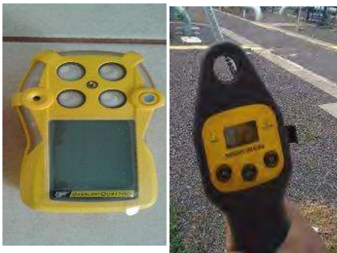
Figura 48. Detectores de fugas de pentano y H 2 S, septiembre 2018.
